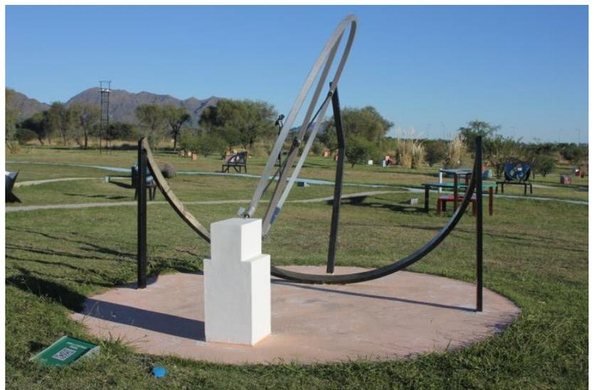
En el montaje original de Brahe la longitud de esa barra es mayor que el diámetro del círculo de las declinaciones. Su extremo superior es sostenido mediante una estructura de vigas levantada por detrás del aro ecuatorial. En la parte superior hay un armazón con forma de letra "U" y con orificios que permiten que gire el eje.
