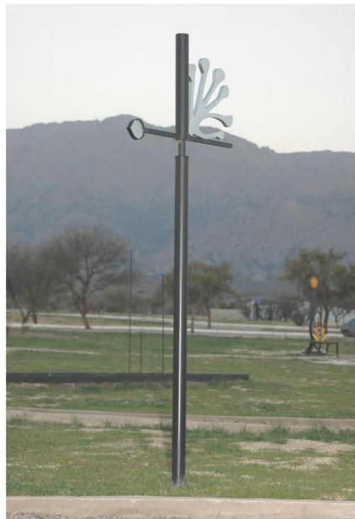
Hemos definido una **zona de veletas** dentro del predio. Cada una de ellas tiene una figura diferente y dimensiones diferentes. Se alzan sobre caños metálicos circulares de casi ocho centímetros de diámetro (7,5 cm) y aproximadamente dos metros de altura.
